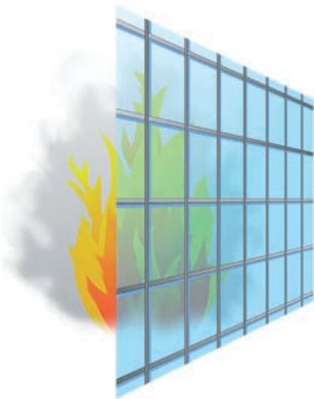
Brand från insida. Utfackningsvägg max höjd 3000 mm.
